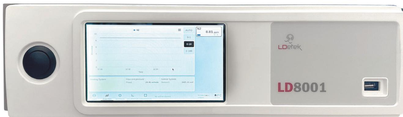
LD8001は、アルゴン/ヘリウム/粗アルゴン中の微量窒素モニタリングを目的としたオンライン測定器です。プラズマ発光検出器(PED検出器)を使用して、アルゴンやヘリウムのバルクガス中の微量窒素を選択的に測定します。
