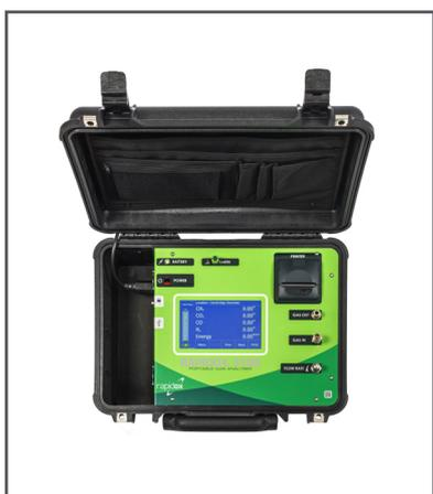
オプションのポンプにより2つの動作モードが可能になります。大気圧以下のガス源から採取されたサンプルの場合、ポンプを起動して分析装置にサンプルガスを引き込みます。大気圧のソースからサンプリングする場合はポンプを停止してサンプルガスがRapidox5100を通過できるようにすることができます。ガス流量は調整バルブを介して手動で調整され画面に表示されます。
